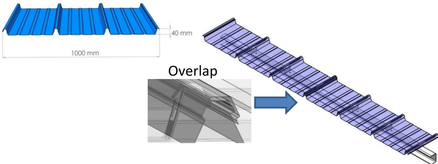
Dengan menggunakan pilihan bahan 55% Aluminium-Zinc yang berkualitas (coating mass 150 gr/m<sup>2</sup> atau 100 gr/m<sup>2</sup>) ataupun 55% Aluminium-Zinc warna, MK-1000 memberikan solusi untuk pemasangan atap tanpa menggunakan baut. Dan dengan lebar efektif 1 meter, MK-1000 juga akan memberikan solusi yang efisien untuk atap anda.
